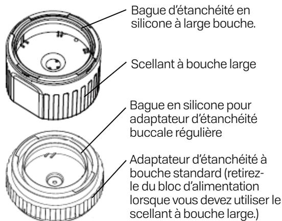
Avant utilisation, vérifiez que l'anneau en silicone est correctement installé. Cela garantira le bon fonctionnement du scellant.
